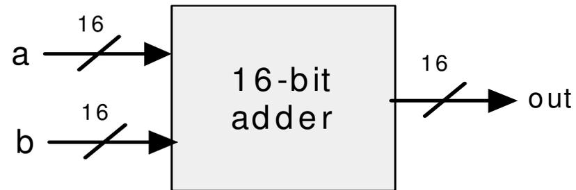
$$\begin{array}{r} \dots \quad 1 \quad 0 \quad 1 \quad 1 \quad a \\ \quad \quad \quad \quad \quad \quad \quad + \\ \dots \quad 0 \quad 0 \quad 1 \quad 0 \quad b \\ \hline \dots \quad 1 \quad 1 \quad 0 \quad 1 \quad out \end{array}$$
